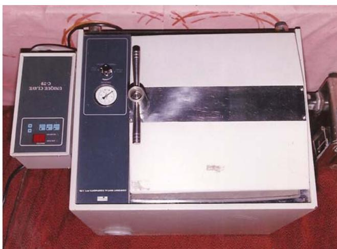
**Fig. 6:** Autoclave (Unique Clave C-79)
