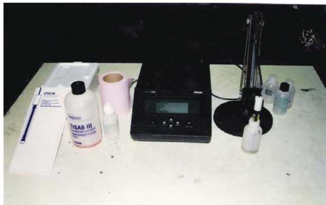
**Fig. 5:** ORION digital ion analyzer
